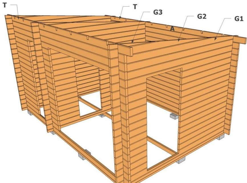
Lägg i takåsarna i urtagen på i T-brädorna. Det längre takutsticket ska vara mot framsidan. De två yttre takåsarna utan urtag skruvas längst ut i T-brädorna.
