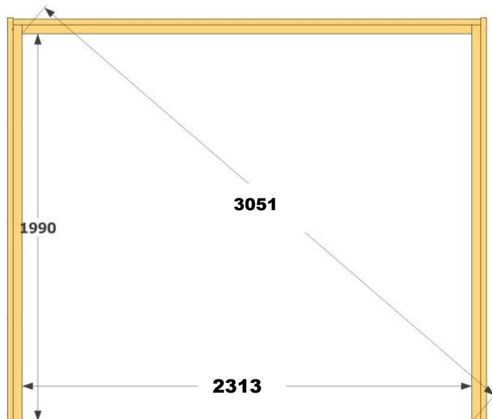
Montera ytterfodren 15mm ut från innerkanten på karmen. Nedre foderbräden monteras jämns med golvet. Skruva enbart i karmen förutom de skruvar som sitter i nedre väggbräden. Där kan man skruva i väggen också. Läs sedan medföljande instruktioner från leverantören av glaspartiet för montering av detta.
