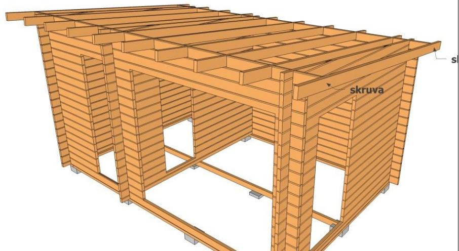
Montera taket. Lägg brädorna med finsidan inåt.
