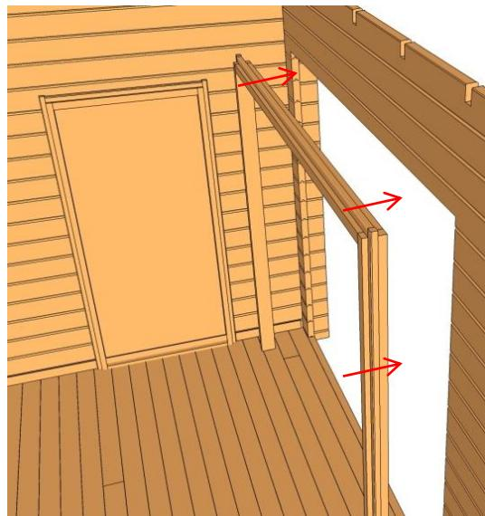
Använd träkilar för att centrera och stabilisera ramen. Skruva endast i den nedre väggbräden.
