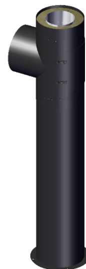
Fig. 14: Gulvstøtte med T-rør. Støtte element under T-stamme kappes i ønsket høyde tilpasset ildsted. Kapp alltid enden på elementet som går opp mot T-stamme for penere skjøt. Husk god nok avstand til vegg, slik at du får åpnet feieluke bak. Finnes i halv og hel isolert utgave (Varenr. 615505031/615305031)
