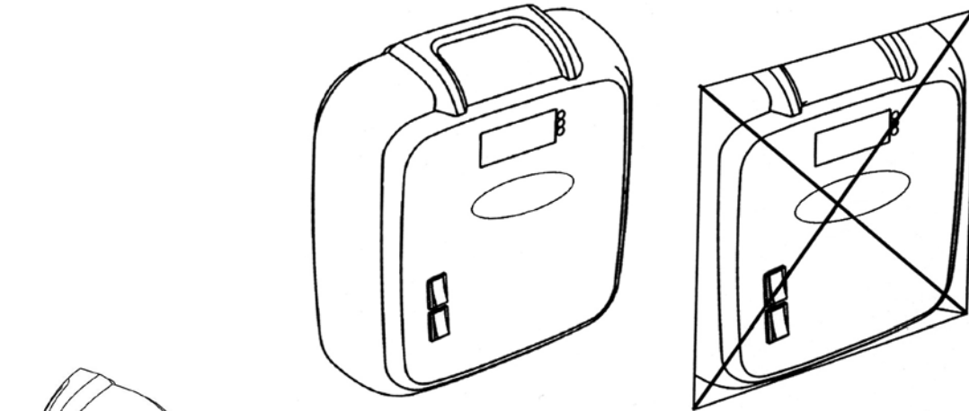
3.attēls. Vadības pulti nedrīkst iegremdēt sienā.
