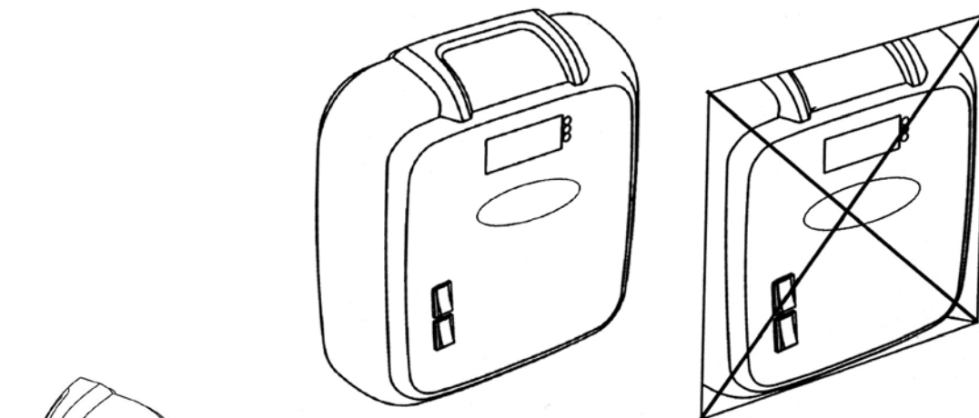
Figura 3. Centrul de control nu trebuie montat încastrat.
